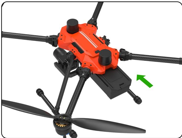
1. 기체 하부에 위치한 배터리 고정대 레일을 따라 배터리를
